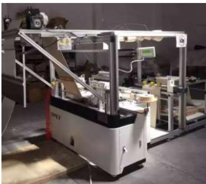
Применение этой машины для длинных труб напольных коврик, продолжения труб с двух сторон и поперечной резки. Что может сэкономить более 6 трудозатрат и 6% потерь ткани. Стоимость может быть покрыта в течение 8 месяцев.
